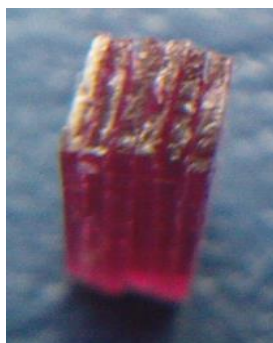
Fig.14. Pure corundum - 0.2x0.2x8.0 mm
